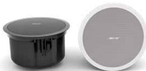
L'enceinte FS4CE est un modèle encastré au plafond doté d'un haut-parleur large bande de 2,25 pouces, avec une restitution des fréquences graves jusqu'à 70 Hz, et d'une sensibilité de 88 dB SPL/1 W à 1 m.
