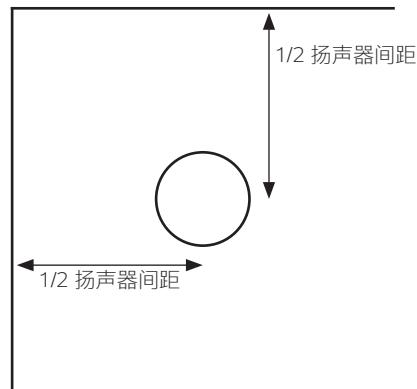
C. 其余扬声器使用 LSD 以方形网格形式排列。如果一个扬声器将被放置在房间边缘或超出边缘，请删除该行/列的扬声器。
