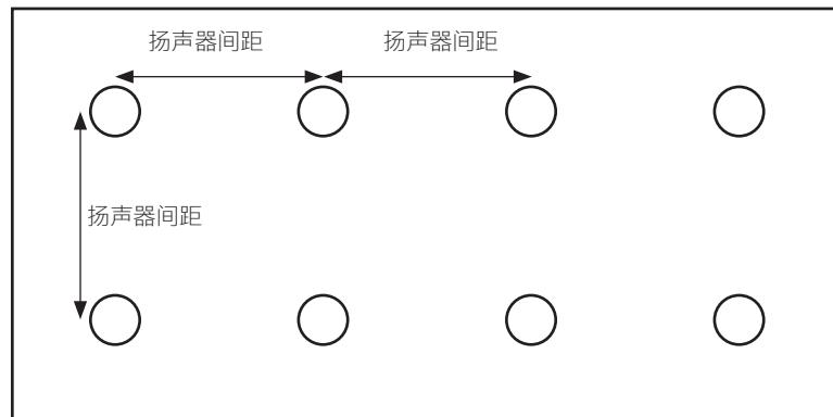
D. 放置好最后一个扬声器后，将那行的扬声器居中排列，让扬声器与墙形成新的补偿距离，这个距离可能不同于  $\frac{1}{2}$  LSD。
