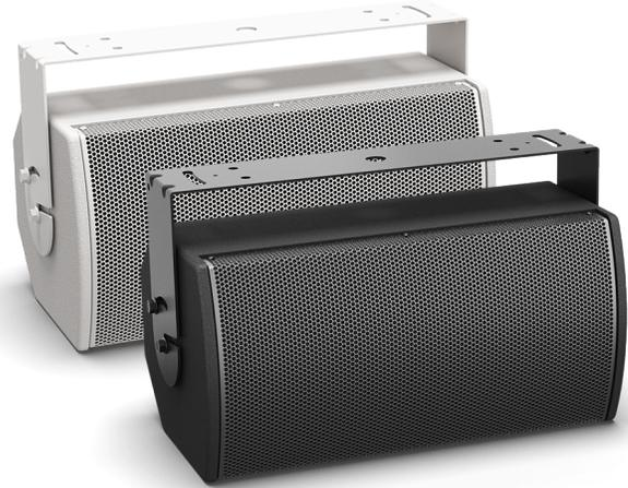
El AMU108 es un modelo pequeño del ArenaMatch Utility diseñado para aplicaciones en exteriores que requieran un audio excelente a partir de un altavoz compacto. Proporciona una cobertura amplia y uniforme con una trompeta de alta frecuencia y de directividad constante de 90° x 60°, una respuesta de frecuencia de 80 Hz - 18 kHz, 121 dB de SPL pico y reproduce los registros vocales más graves con un woofer LF8 de 8 pulgadas de Bose Professional.
