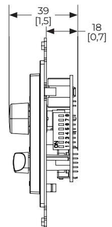
1. Die Abmessungen sind in Millimetern angegeben (Zollangabe in Klammern).
