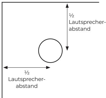
C. Die restlichen Lautsprecher werden mithilfe des LSD nach einem quadratischen Gittermuster angeordnet. Wenn ein Lautsprecher an oder hinter den Raumgrenzen platziert werden würde, löschen Sie diese Zeile/Spalte mit Lautsprechern.
